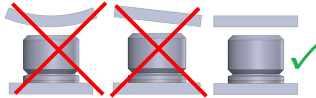
Bild 4: Gegendruckplatten eben und parallel führen
